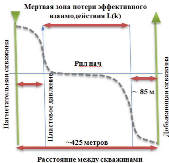
Рис. 7. Формирование "мертвой" зоны потери взаимодействия между нагнетательной и добывающей скважинами при несоответствии плотности сетки скважин проницаемости пласта (иллюстрация автора)
